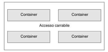
l'intero modulo avrà la forma di un rettangolo, per una superficie totale di 10 x 29 metri  $\cong$  300 m $^2$
