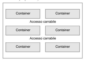
l'intero modulo avrà la forma di un rettangolo, per una superficie totale di 16 x 28 metri  $\cong$  450 m $^2$
