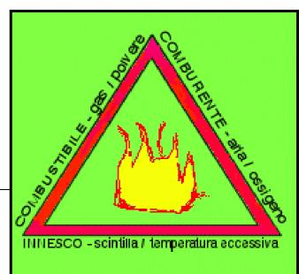
sufficiente di ossigeno (comburente) ed una fonte di ignizione, come si evince dal "triangolo del fuoco" di seguito riportato.
